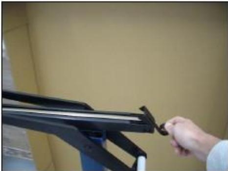
1. Tire el empujador (026) hacia atrás hasta que pare en el tope (024). Después dé vuelta al empujador (026) hasta su posición.
