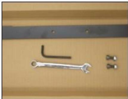
2. Use la llave hexagonal de 6 mm y una llave de tuercas para montar el balanceador (049).
