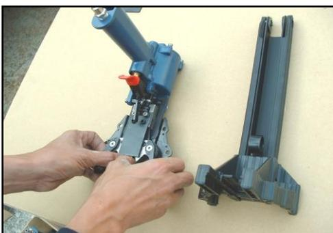
4. Resbale el mecanismo del acoplamiento y ajuste de la barra (018) simultáneamente desde el collar (006).
