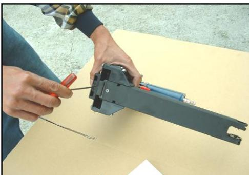
3. Afloje el tornillo de presión (526) con una llave hexagonal de 3mm para abrir el ajuste de la barra.
