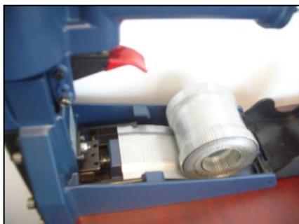
3. Coloque la tira de grapas en el compartimento. Alimente el extremo delantero de las grapas de la bobina en la guía derecha de la bobina (037). Empuje hacia adelante hasta parar en la unidad de la guía del conductor (027).
