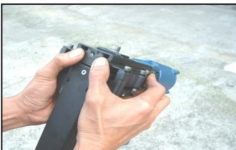
2. Empuje el cuerpo (007) hacia arriba y ajuste a la profundidad deseada.
