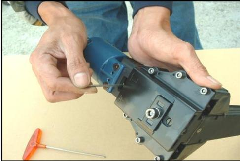
1. Utilice la barra de 3 mm (diámetro) o la llave hexagonal de 2.5G mm. Gire el collar hacia la derecha (006) a través de la ventana para apretar el ajustador del cierre de la grapa y a la izquierda para aflojarlo.
