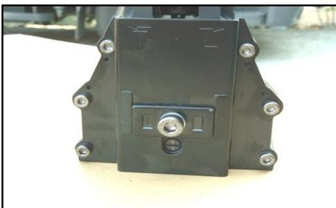
3. Cuando el borde superior de la placa de ajuste (019) está en su ajuste (No.4), las cuchillas (021,022) están en su penetración más baja. Si el sistema está en el ajuste más bajo (No.1) las cuchillas (021,022) están en su penetración más profunda.
