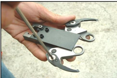
3. Afloje los tornillos (510) con la llave hexagonal de 3mm. Cambie las cuchillas una a la vez para evitar invertirlas.
