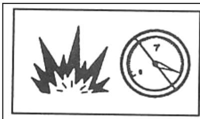
2. Regule la presión de aire para obtener 6 KG/Cm<sup>2</sup> en la herramienta.
