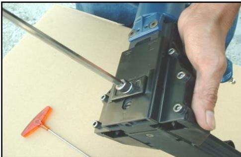
1. Afloje el tornillo delantero (527) con la llave hexagonal de 6 mm.
