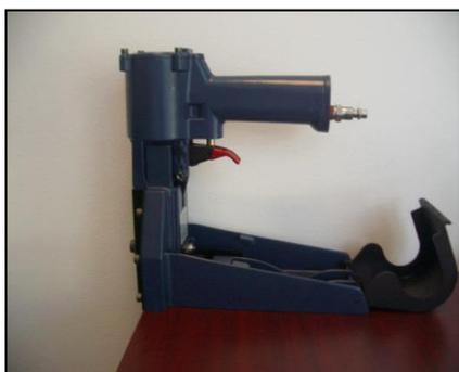
2. Dé un ligero apretón a la parte posterior de la cubierta (044), después tire levemente para abrirla (044).
