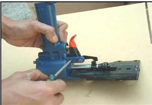
1. Afloje los tornillos (513) con un desatornillador plano
