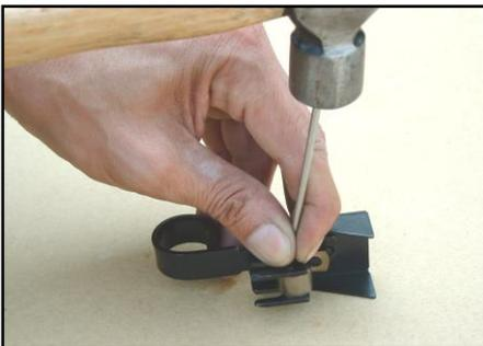
5. Afloje los tornillos (535) con la llave hexagonal de 3mm. Saque el resorte (537) con el martillo y la barra recta de 6 mm.
