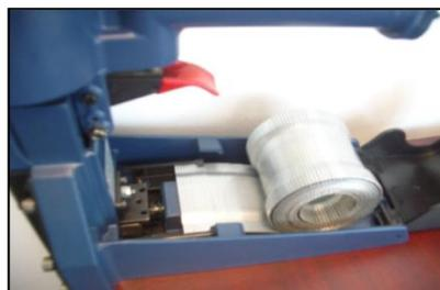
3. Inserte la tira de grapas dentro de la herramienta siguiendo las instrucciones de cargando la herramienta.
